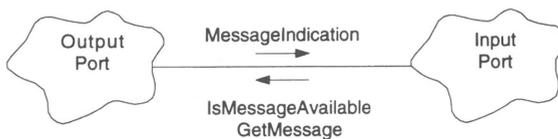
**Bild 4.6:** Handshake-Protokoll zum Nachrichtenaustausch zwischen Ports
