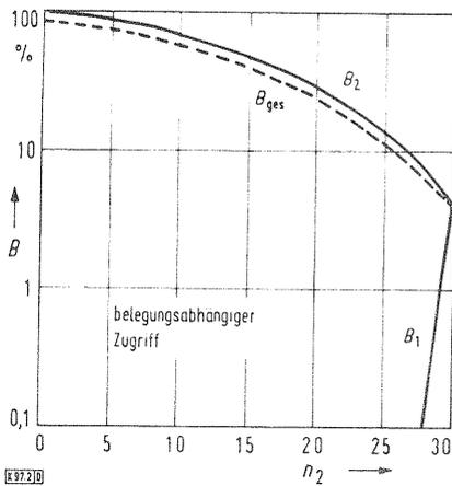
Bild 2. Die Verlustwahrscheinlichkeiten  $B_1$  und  $B_2$  bei belegungsabhängigem Zugriff in Abhängigkeit von der Leitungszahl  $n_2$  mit  $n_1 + n_2 = 30$ ,  $A_1 = 4$ ,  $A_2 = 20$ .
