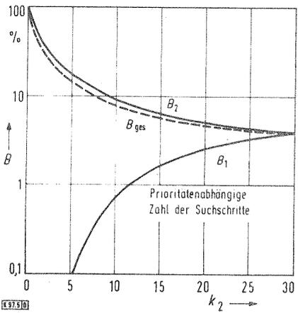
Bild 5. Die Verlustwahrscheinlichkeiten  $B_1$  und  $B_2$  beim System mit prioritätenabhängiger Zahl der Suchschritte in Abhängigkeit von der Erreichbarkeit  $k_2$  mit  $n_1 + n_2 = 30$ ,  $A_1 = 4$ ,  $A_2 = 20$ .
