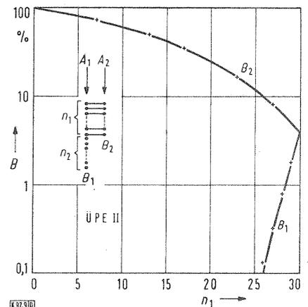
Bild 9. Die Berechnung der Verlustwahrscheinlichkeiten  $B_1$  und  $B_2$  bei ÜPE II nach dem Streuwertverfahren (ausgezogene Kurve) in Abhängigkeit von  $n_1$  mit  $n_1+n_2=30$ ,  $A_1=4$ ,  $A_2=20$ . Die Funktionswerte der exakten Lösung (+) sind zum Vergleich ebenfalls eingetragen.
