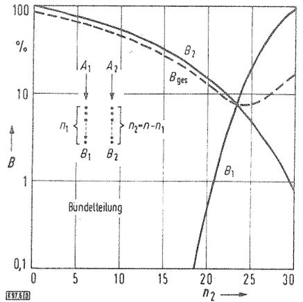
Bild 6. Die Verlustwahrscheinlichkeiten  $B_1$  und  $B_2$  bei der Bündelteilung in Abhängigkeit von der Leitungszahl  $n_2$  mit  $n_1 + n_2 = 30$ ,  $A_1 = 4$ ,  $A_2 = 20$ .
