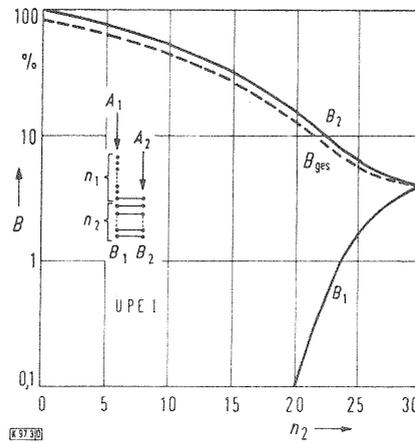
Bild 3. Die Verlustwahrscheinlichkeiten  $B_1$  und  $B_2$  bei ÜPE I in Abhängigkeit von der Leitungszahl  $n_2$  mit  $n_1 + n_2 = 30$ ,  $A_1 = 4$ ,  $A_2 = 20$ .
