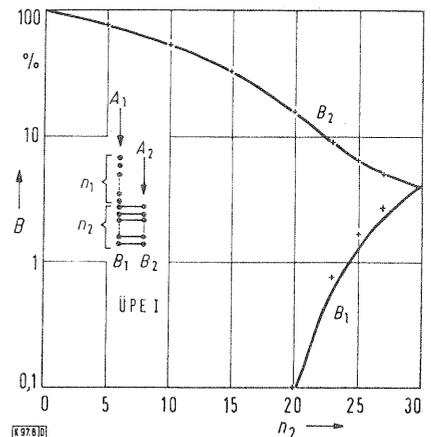
Bild 8. Die Berechnung der Verlustwahrscheinlichkeiten  $B_1$  und  $B_2$  bei ÜPE I nach dem Streuwertverfahren (ausgezogene Kurve) in Abhängigkeit von  $n_2$  mit  $n_1+n_2=30$ ,  $A_1=4$ ,  $A_2=20$ . Die Funktionswerte der exakten Lösung (+) sind zum Vergleich ebenfalls eingetragen.
