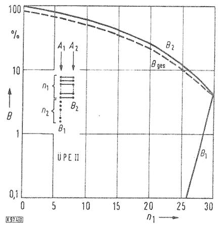
Bild 4. Die Verlustwahrscheinlichkeiten  $B_1$  und  $B_2$  bei ÜPE II in Abhängigkeit von der Leitungszahl  $n_1$  mit  $n_1 + n_2 = 30$ ,  $A_1 = 4$ ,  $A_2 = 20$ .
