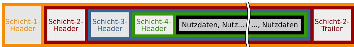
**Abbildung 2.4:** Beispiel der hierarchischen Schachtelung der zu übertragenden Nutzdaten mit den Headern und Trailern der verschiedenen Schichten
