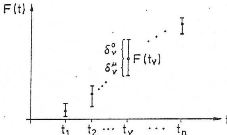
**Bild 3:** Gegebene diskrete Werte der VF  $F(t)$  an den Stellen  $t_1, \dots, t_n$  mit maximalen Abweichungen  $\delta_v^o, \delta_v^u$  von Approximation und  $F(t)$ .
