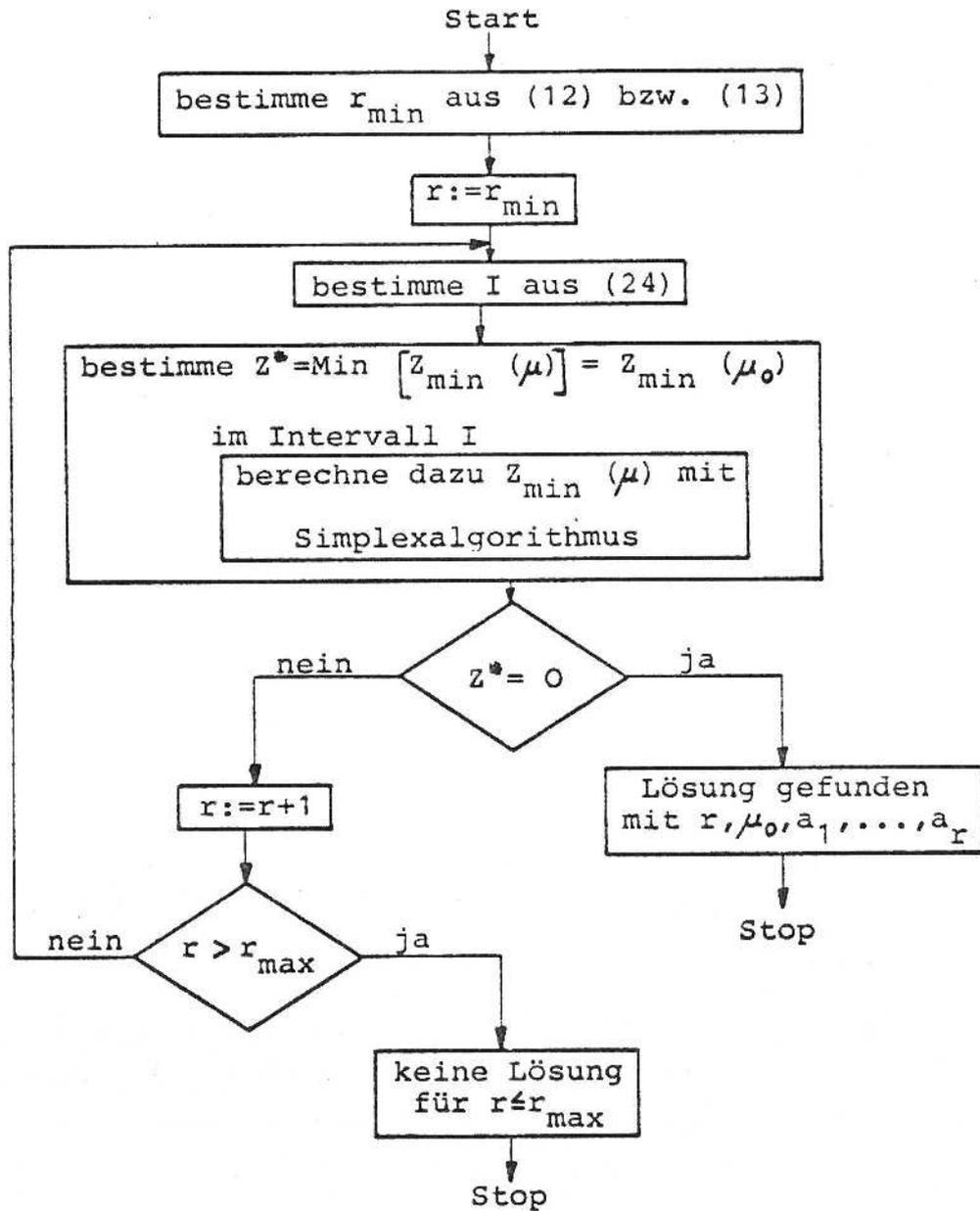
Bild 4: Algorithmus zur Bestimmung einer approximierenden VF
