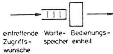
Bild 7: Warteschlangenmodell für Plattenspeicherzugriff
