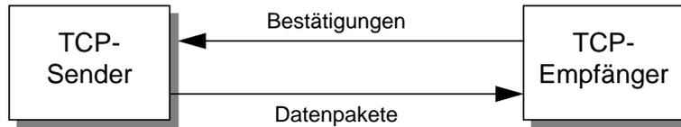
**Bild 4.3:** Unidirektionales TCP-Modell
