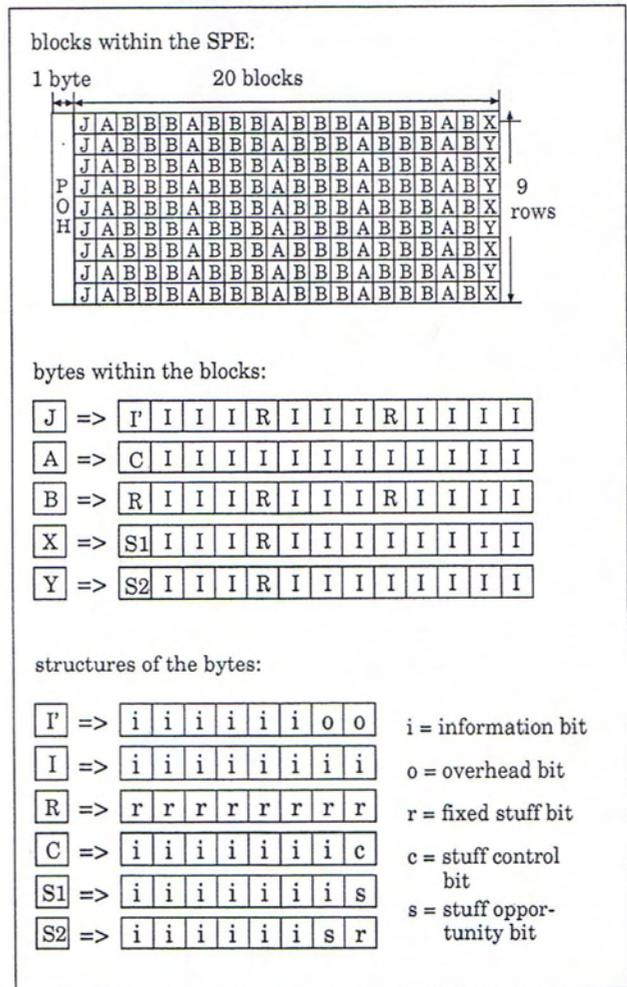
Fig. 3: Super-Rate Mapping
